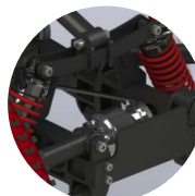
nezávislé odpružení a diferenciál
